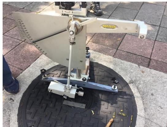
英式擺錘測試儀(British Pendulum Tester)
