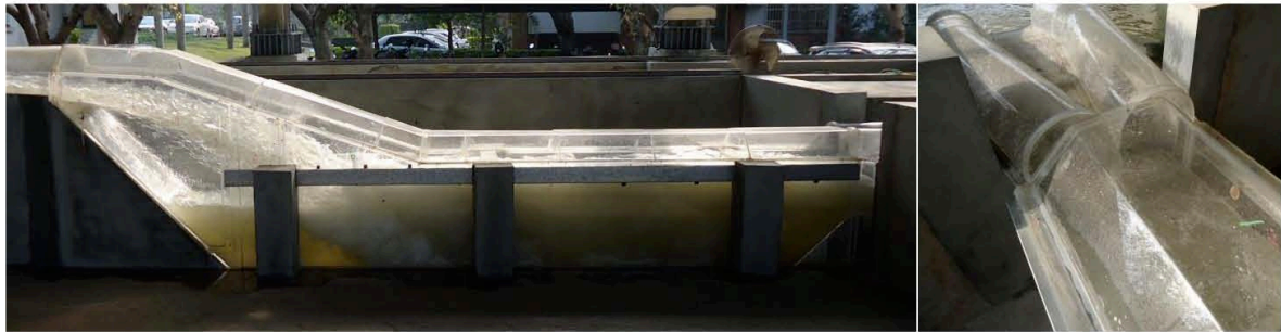
圖B16 消能池水工模型試驗情形
