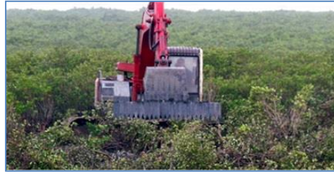
圖8 紅樹林機械清除用之120型鏟斗前加焊長耙
