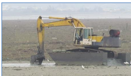
圖27 浮筏載具滑行灘地之情形
