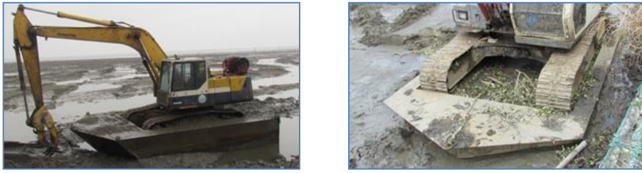
圖6 紅樹林機械清除用之T200型(左)與T120型(右)浮筏
