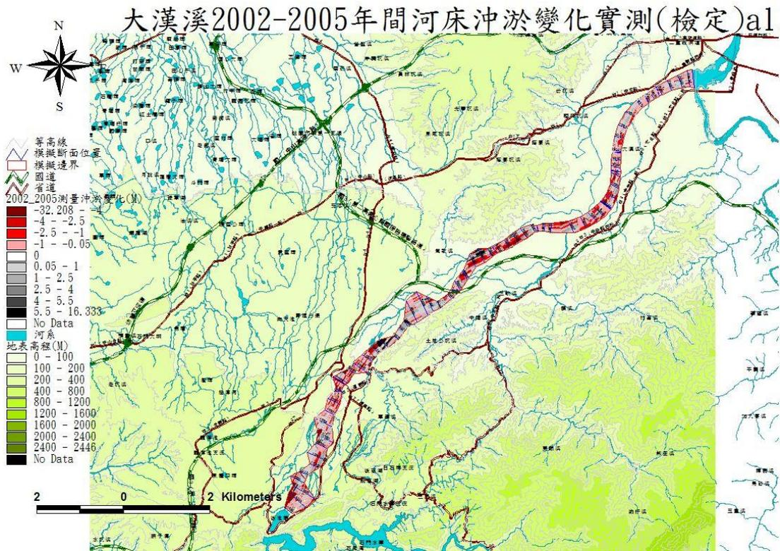
圖 22 石門水庫下游河道 2002 年底至 2005 年底間實測河床沖淤變動圖
