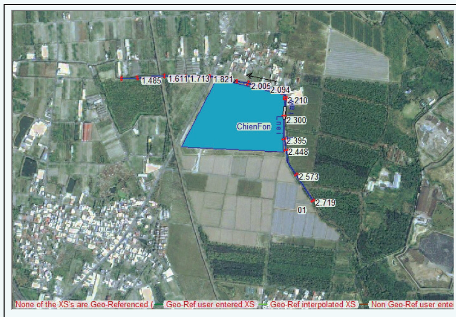
附圖二 HEC-RAS 模式模擬排水路系統建置平面圖
