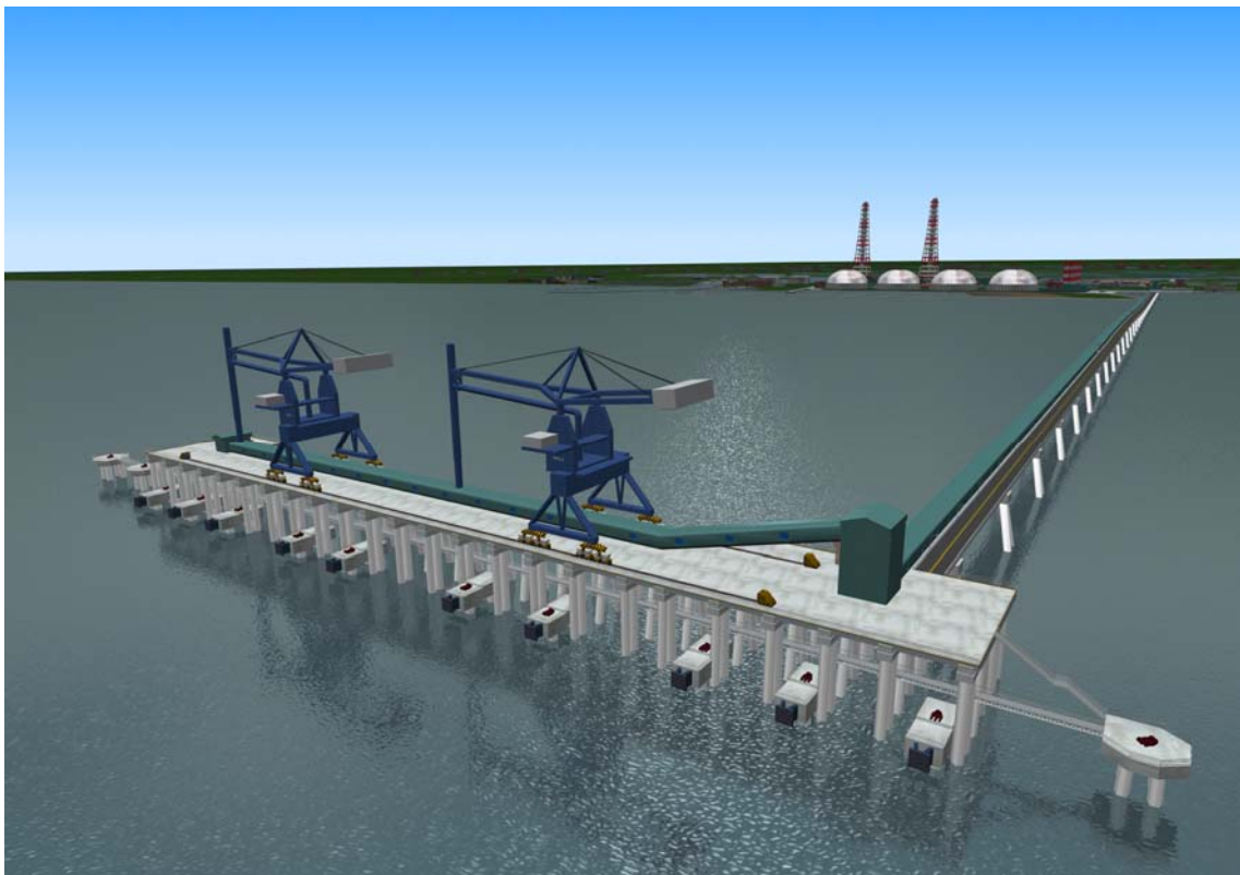
圖 5 興達電廠外海卸煤碼頭及連絡棧橋 3D 影像模擬圖(近景)
