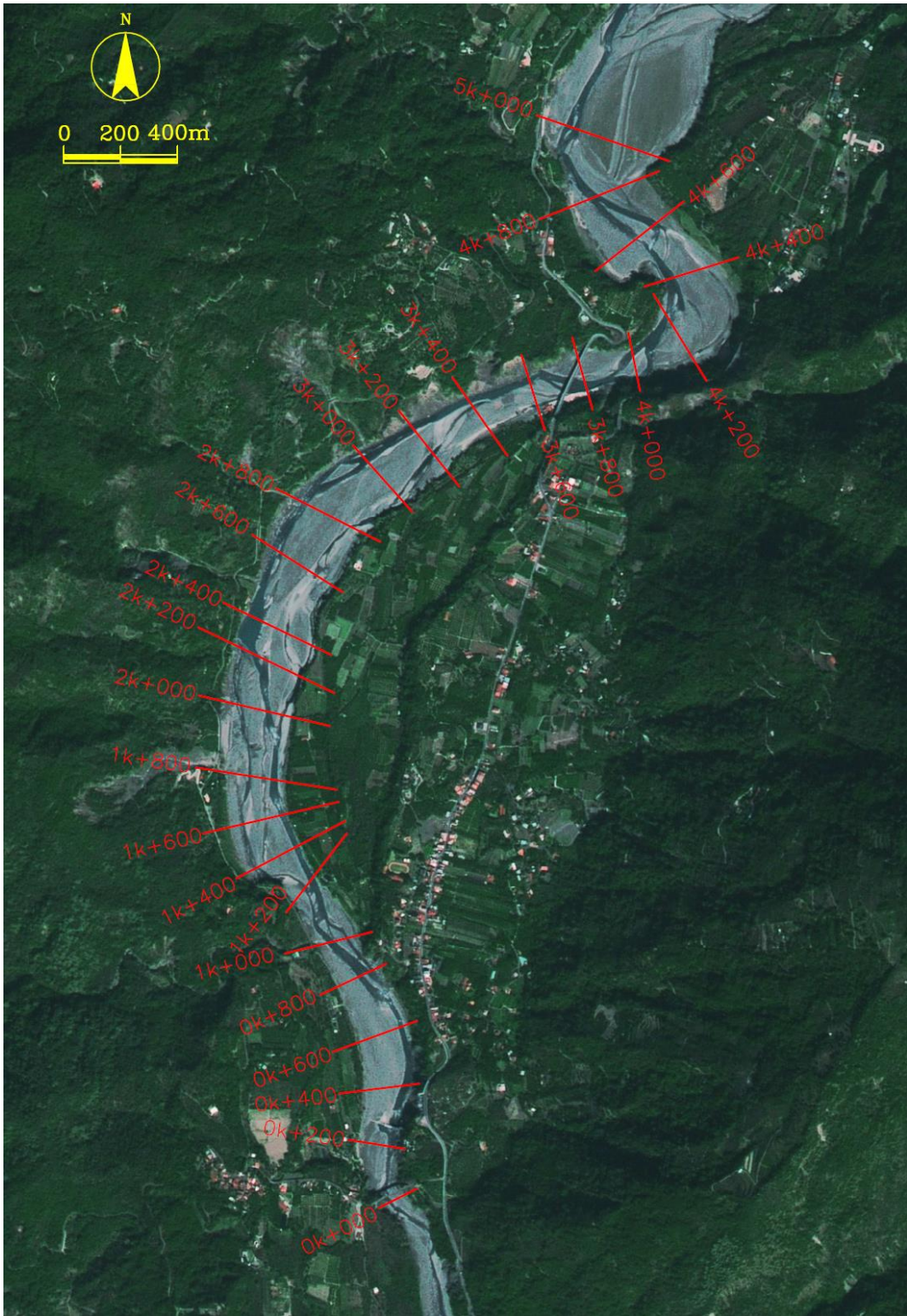
圖 3 荖濃溪河道斷面測量位置圖
