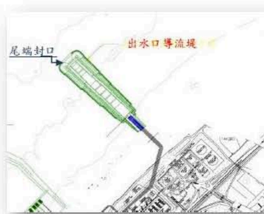
大潭電廠出水口-導流堤導水尾端封閉開口排放
