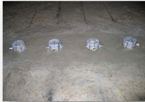
通霄電廠潛式排放出水口之水工模型
